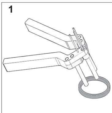
**DIE DICHTUNG DARF KEINE METALLTEILE ENTHALTEN.** DICHTUNG SO AUF EINE GLATTE FLÄCHE LEGEN, DASS DIE DICHTKLIPPE IN DIE GEWÜNSCHTE RICHTUNG ZEIGT. DAS WERKZEUG IST MIT EINSCHRAUBBAREN STIFTEN VERSEHEN, DIE JE NACH ABMESSUNG DER DICHTUNG, IN ZWEI VERSCHIEDENE POSITIONEN EINGEDREHT WERDEN KÖNNEN.
