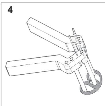
DICHTUNG SORGFÄLTIG AN DER GEWÜNSCHTEN STELLE PLATZIEREN UND DURCH ÖFFNEN DER GRIFFE IN DEN DICHTSITZ EINFÜHREN. DICHTUNG AUF UNNATÜRLICHE SPANNUNGEN ODER VERDREHTE LAGE IN IHRER AUFNAHME ÜBERPRÜFEN
