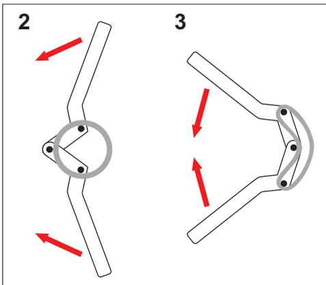
STIFTE JE NACH GRÖSSE DER DICHTUNG EINSETZEN, ZANGE ÖFFNEN UND STIFTE WIE IN DER ABBILDUNG (2) GEZEIGT AN DER DICHTUNG ANLEGEN. ZANGE LANGSAM SCHLIESSEN (3), DABEI WIRD DIE DICHTUNG GEBOGEN, OHNE DASS DABEI DIE GEFAHR BESTEHT, DIE DICHTUNG ZU ZERSTÖREN. DAS KANN NÜTZLICH SEIN, WENN DER VORHANDENE EINBAURAUUM SEHR ENG IST.
